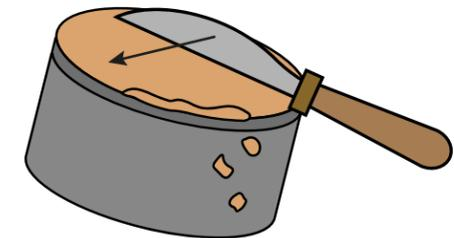
**6** Guarde la muestra dentro de una bolsa de plástico con cierre usando el cuchillo de hoja ancha. Cierre y etiquete la bolsa (lugar, coordenadas, ID, fecha y colector).
